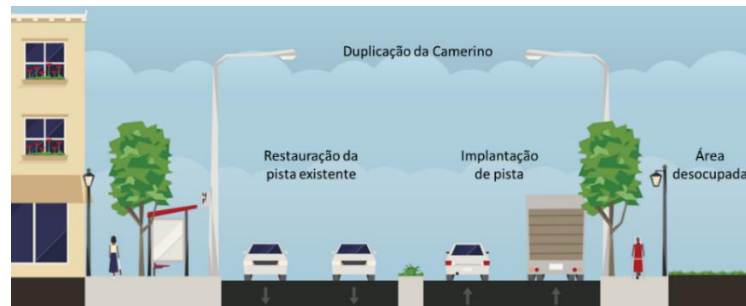
Figura 13: Seção esquemática do Sistema Camerino duplicado
