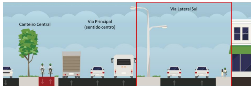
Figura 6: Seção esquemática da Via Lateral Sul
