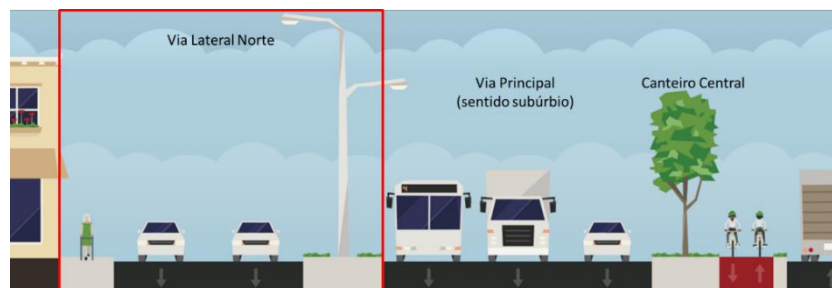
Figura 7: Seção esquemática da Via Lateral Norte
